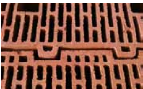
Particolare della geometria del 38x22,5x19 c55 ST ad incastro
