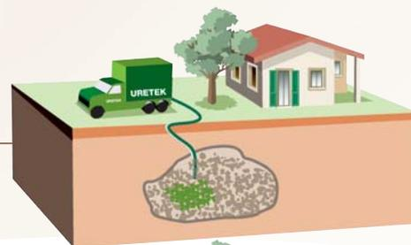
**Fase 3 - Espansione della resina Geoplus® e precompressione della calotta**
