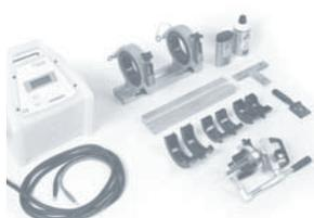
Attrezzatura per installazione raccordi a polifusione (a noleggio)
