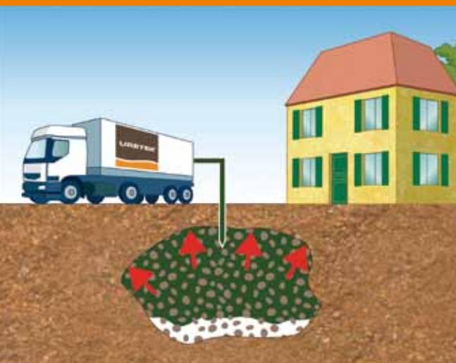
**3** Saturazione e precompressione della volta della cavità
