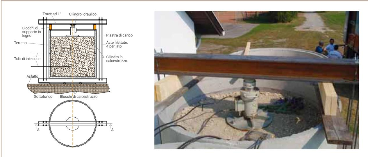
Schema del dispositivo di prova
