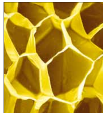
Struttura poliedrica a celle chiuse di Gematherm XC con ingrandimento 300 e 700 volte con microscopio elettronico a scansione SEM
